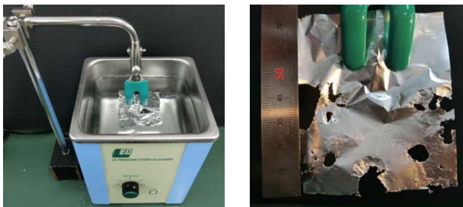
（図1）超音波洗浄機とアルミ箔を用いたキャビテーションエロージョンの実験
